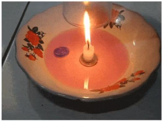
**Почему так происходит.** Когда свечка погасла, разгорячённый воздух стал остывать и, соответственно, уменьшаться в объёме. Давление внутри стакана стало стремительно падать, и вода из тарелки заполнила пустующее место.
